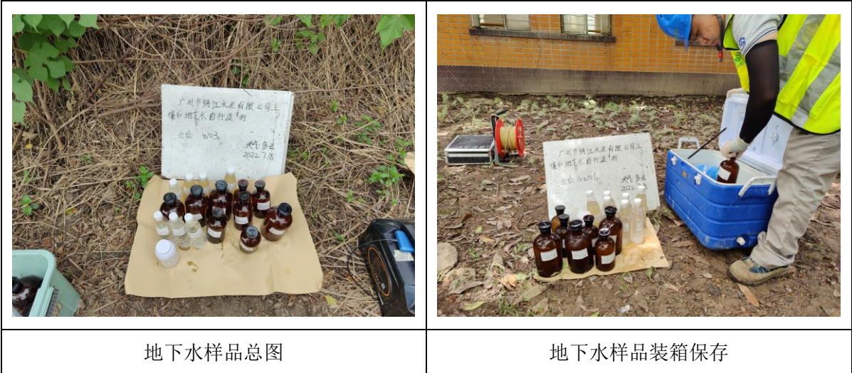
图 6.1-2 地下水监测井建井、洗井、采样部分现场照片
